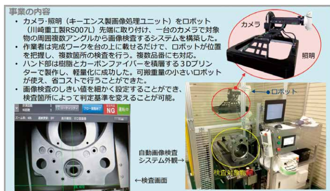
図1 実装に結びついた事例 「ロボットとカメラによる自動画像検査システム」
